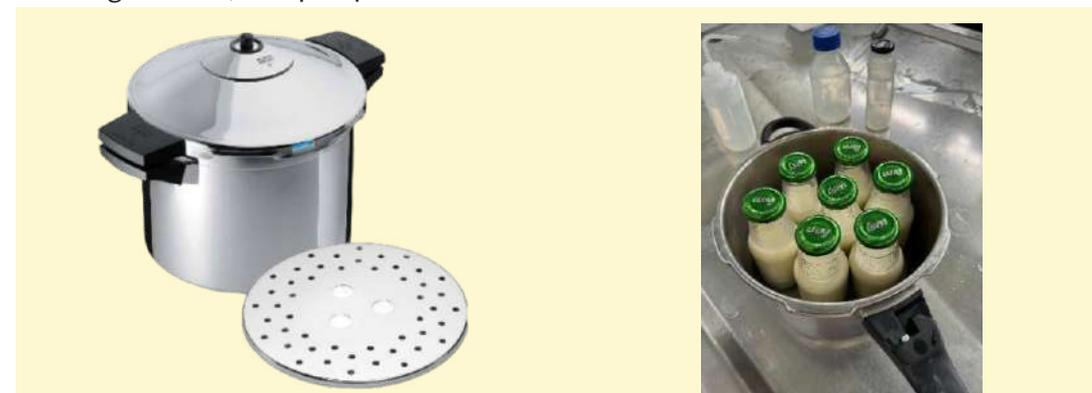
Olla a presión con base insertable y con botellas listas para esterilizar
