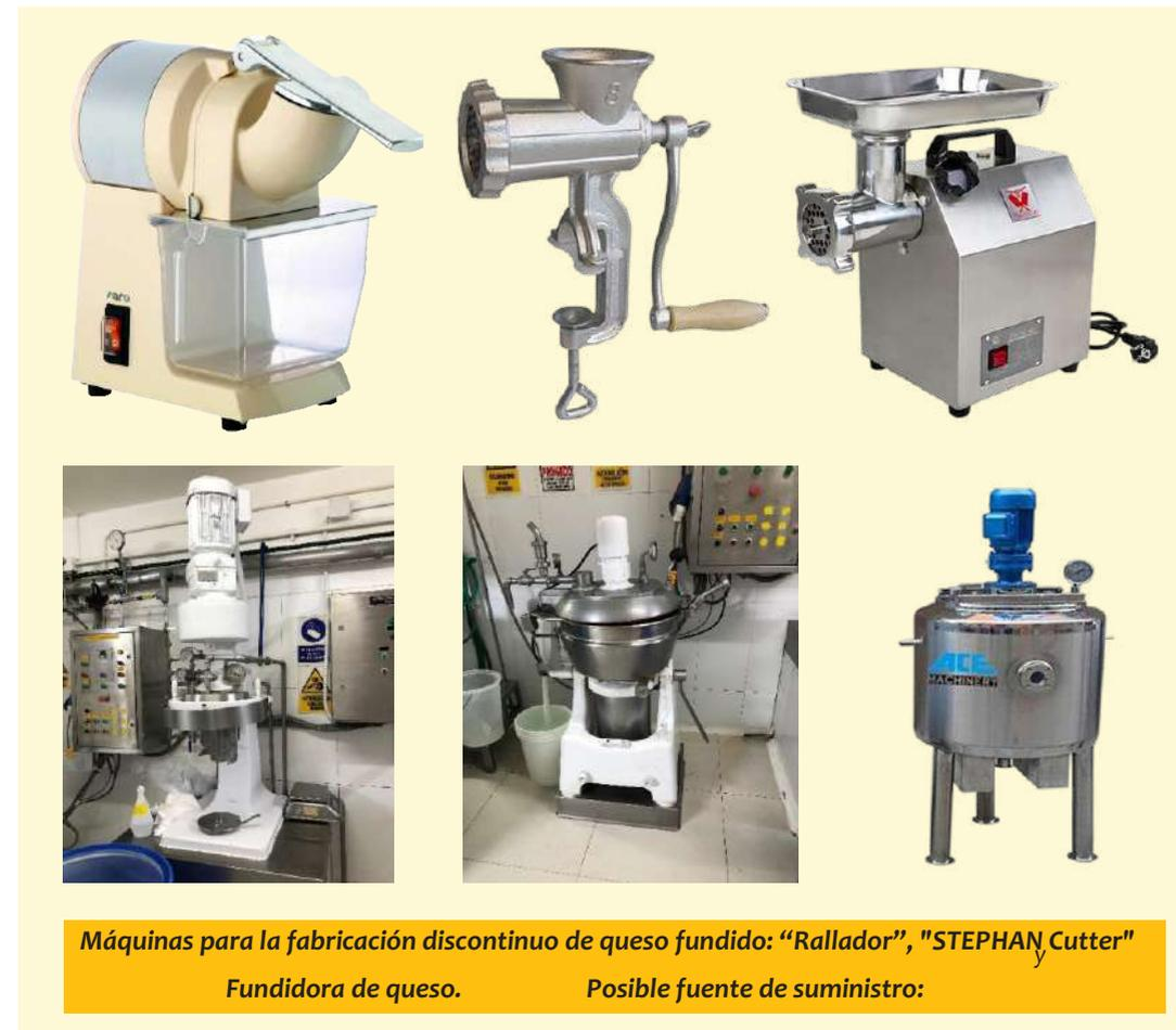
Máquinas para la fabricación discontinuo de queso fundido: "Rallador", "STEPHAN Cutter"
