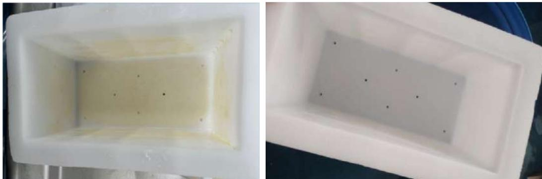
Imágenes: Molde de queso de plástico antes de la limpieza (con una capa de “piedra de leche”) y después de la limpieza en un baño de ácido fosfórico (solución al 2% durante 10 horas).
