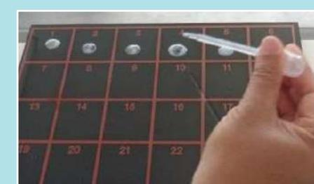
Colocación de 1 gota de hidróxido de sodio en la leche
