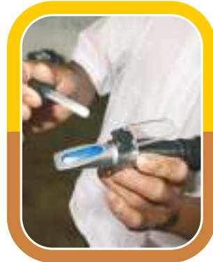
Colocar una gota de leche en el portamuestra del refractómetro
