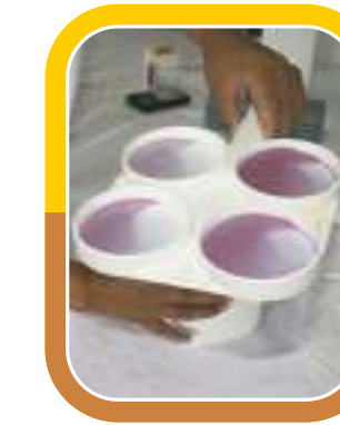
Rote la raqueta con movimientos circulares hasta mezclar totalmente el contenido. No lo mezcle por más de 10 segundos.
